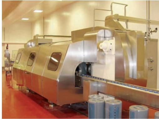
Figura 9 - Equipo industrial de altas presiones (modelo Wave 6000/300 de NC Hyperbaric -
