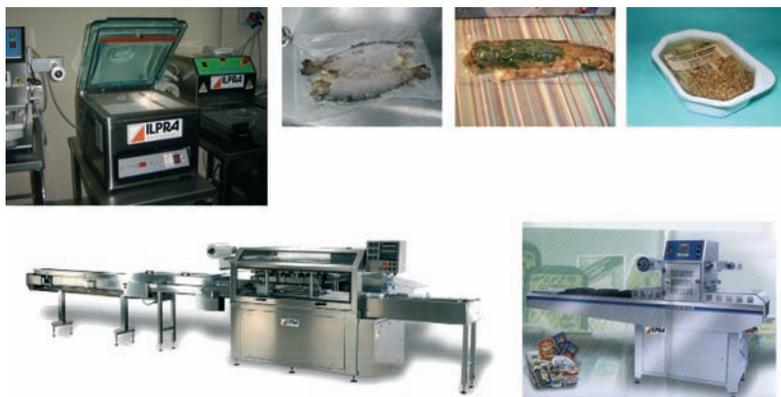
Figura 9 - Termoselladores al vacío.
