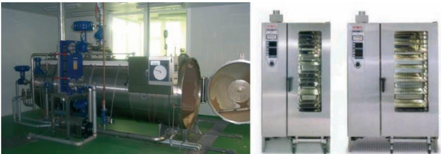
Figura 3 - Cocedor/pasteurizador y hornos de vapor.
