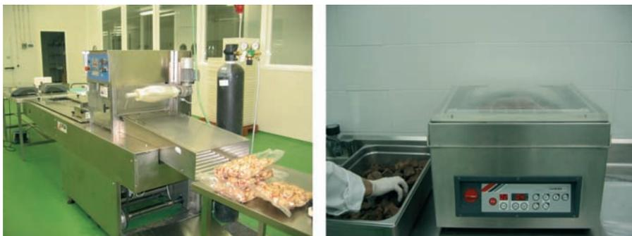
Figura 2 - Envasadoras a vacío.
