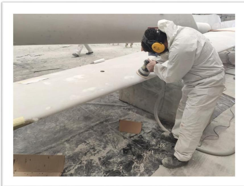
**Lijado con máquina orbital**
