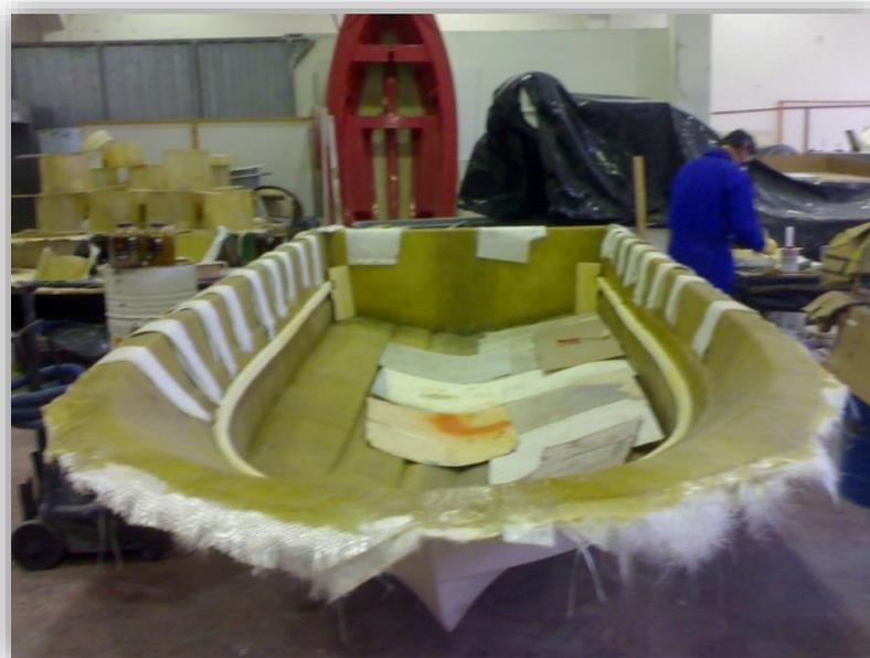
**Reforzado longitudinal con núcleo de poliuretano**
