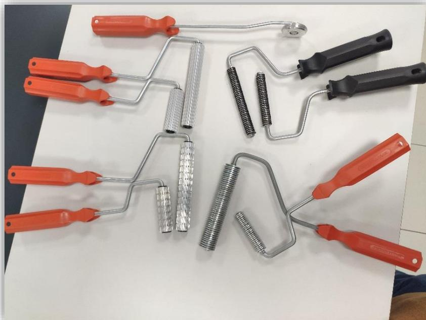
**Diferentes tipos de rodillos antiburbujas metálicos**
