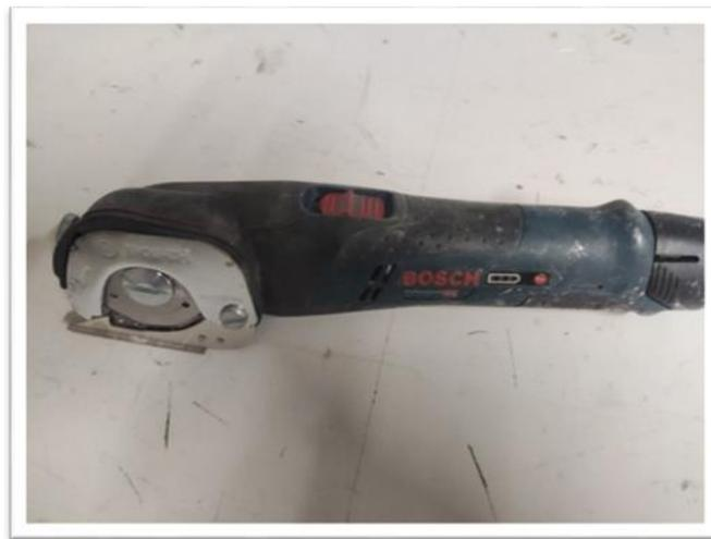
**Cortadora de fibra a batería**
