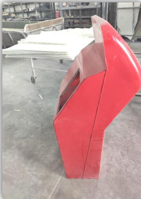
**Pieza de consola fabricada con molde partido**
