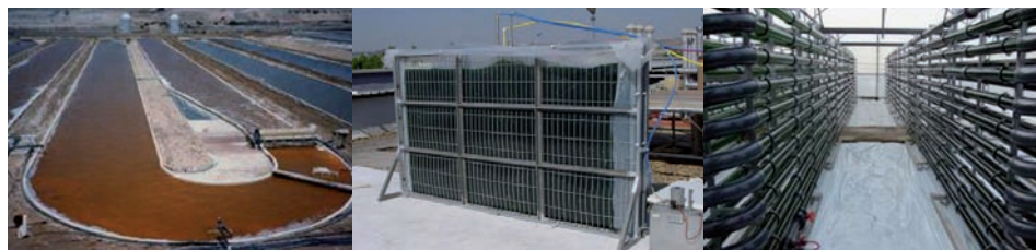
Figura 5. Imágenes de las tres tecnologías más utilizadas de cultivo de microalgas: open raceways (izquierda), reactores verticales planos (centro) y reactores tubulares (derecha).
