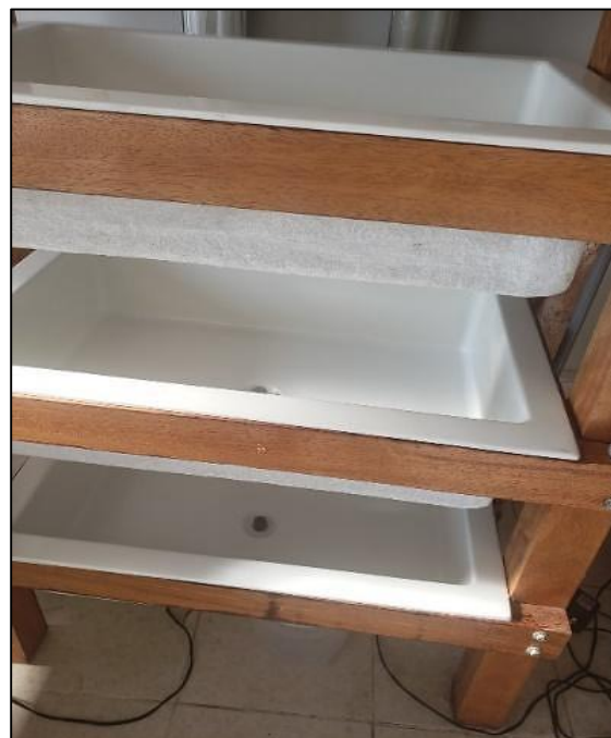
Figura 61: Sistemas de asentamiento de "yuyo" sobre los cuales se colocan los bastidores. Fuente: Laboratorio de Investigación en Cultivos Marinos (LICMA-UCSUR).
