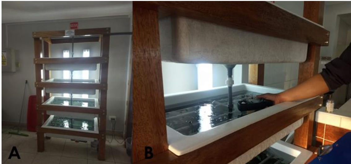
Figura 62: sistemas de pre-incubación de “yuyo”. En A, batería de tinajas de pre-incubación de 40L de capacidad con un sistema de recirculación del agua de mar y fotoperiodo controlado. En B, control y medición de los parámetros fisicoquímicos del medio de cultivo. Fuente: Laboratorio de Investigación en Cultivos Marinos (LICMA-UCSUR).
