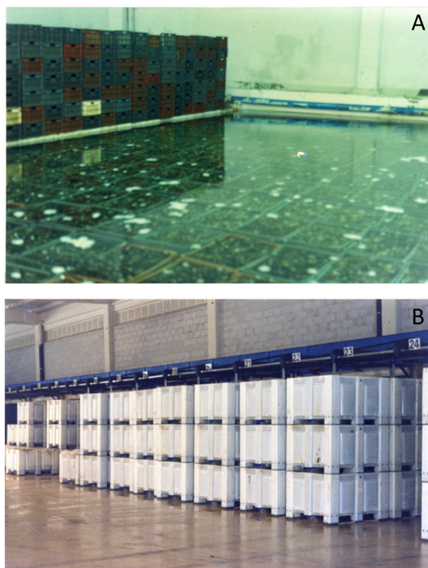
Figura 2. Diferentes tipos de plantas de depuración de moluscos de circuito abierto: en tanques de cemento (A) o en bins apilables (B). (Fotografías de J.L. Romalde).
